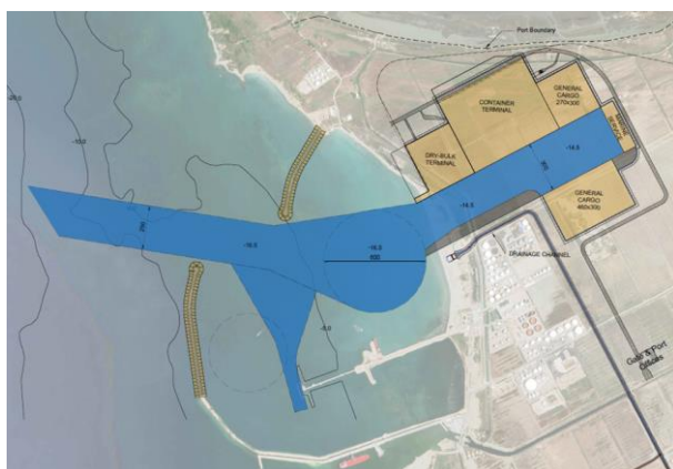
Figura 4-5: Skema e zhvillimit të portit në tokë dhe në det e cila u përdor për krahasimin e kostos
