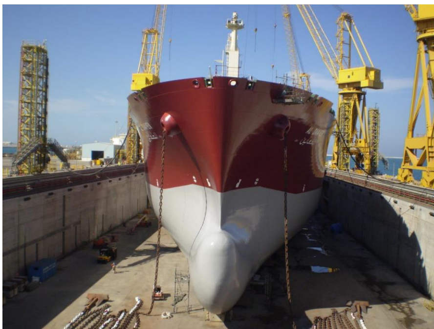
Figura 5-15 Fotografia e objektit të fiksuar të dokut të thatë
