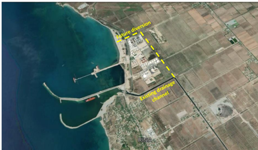
Figura 3-28: Kanalet kullues ekzistues & devijimi në të ardhmen Burimi: Google Earth
